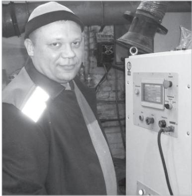
– Эта высоко-частотная установка предназначена для индукционной пайки выводов обмоток статоров тяговых электродвигателей, – рассказывает Олег Валерьевич, указывая на компактный аппарат со
